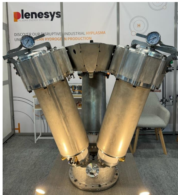
Figure 1 : Torche à Plasma AC - 100kW - Paris - HyVolution 2024
